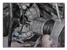
1. Снимите привод левого переднего колеса (см. «Снятие и установка приводов передних колес», с. 176).
