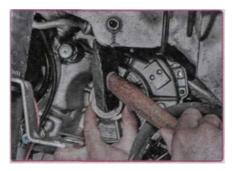
3. Смажьте рабочую кромку сальника трансмиссионным маслом и запрессуйте его с помощью оправки подходящего диаметра рабочей кромкой внутрь коробки передач.
