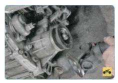
1. Снимите карданный вал (см. «Снятие и установка карданной передачи», стр. 130).
