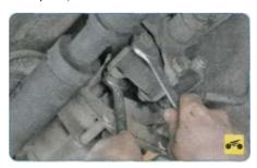
5. Отверните три гайки болтов крепления эластичной муфты к фланцу вторичного вала коробки передач.
