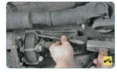
6. Извлеките болты из отверстий муфты и фланца. Если болты выходят тяжело, воспользуйтесь бородком и молотком.
