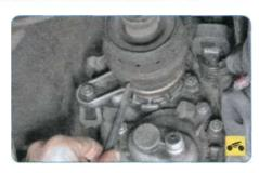
2. При помощи молотка и зубила аккуратно отметьте взаимное расположение корпуса ШРУСа и фланца раздаточной коробки.
