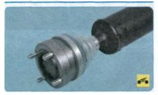
Шарниры равных угловых скоростей переднего и заднего карданного вала на автомобилях с 2010 года не требуют замены или пополнения смазки в течение всего срока службы.
