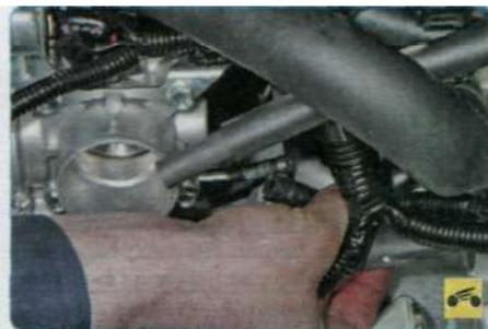
4. Сжав пассатижами ушки хомута верхнего (подводящего) шланга, сдвиньте хомут по шлангу и отсоедините шланг от патрубка дроссельного узла.
