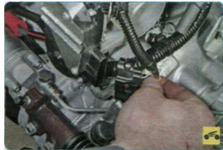
3. Сожмите фиксатор колодки жгута проводов и отсоедините колодку от дроссельного узла.
