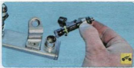
3. ...и извлеките хвостовик форсунки из отверстия рампы.
