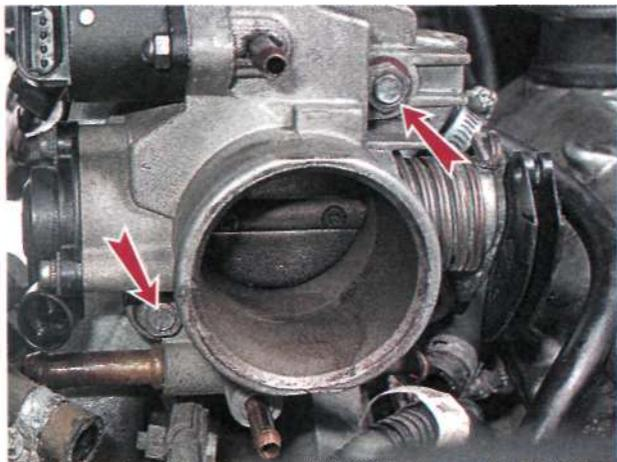
10. Снимаем дроссельный узел, а затем его прокладку.
