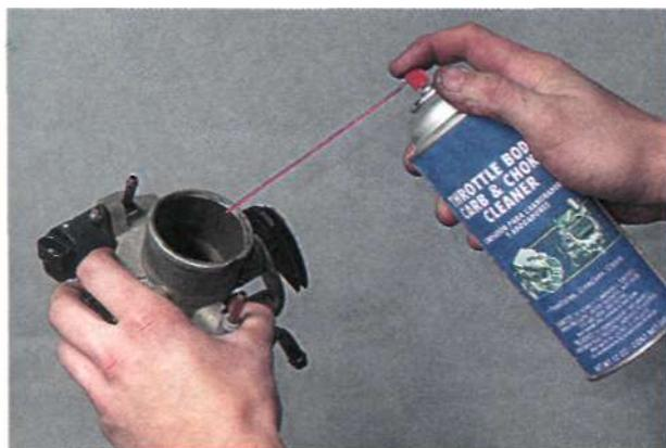
13. Очищаем воздушный канал холостого хода.
