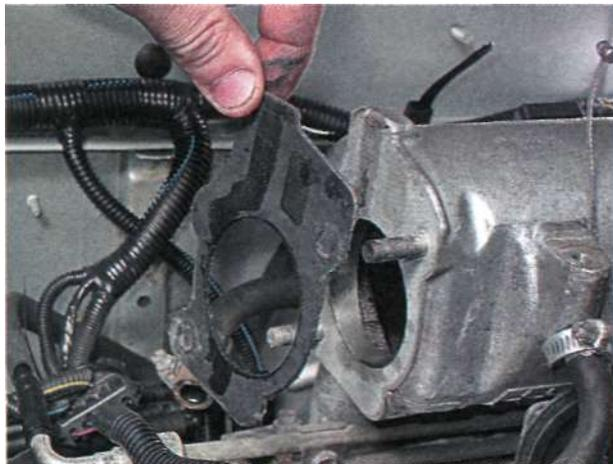
11. Устанавливаем прокладку в обратной последовательности.
