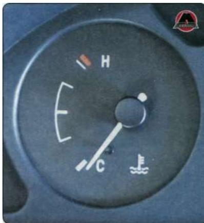
Переход стрелки данного указателя в красную зону шкалы указывает на перегрев двигателя. В этом случае следует проверить работу термостата и электровентилятора системы охлаждения.
