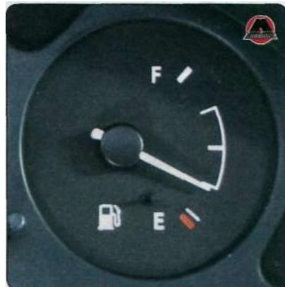
При включении зажигания данный указатель отображает приблизительное количество топлива в баке. Если топливо в баке почти заканчивается (осталось менее 10 литров), стрелка приближается к делению «Е» («пусто») на шкале и загорается соответствующая сигнальная лампа Щ, предупреждающая о необходимости заправки. В этом случае рекомендуется заправиться топливом как можно скорее.
