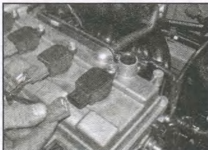
6 При выключенном двигателе следует снять воздухоочиститель и дроссельный блок, после чего необходимо проверить надежность подсоединения штекеров к четырем катушкам зажигания.
