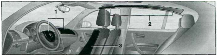
Рис. 1.73. Размещение НПБ. 1 - фронтальные НПБ водителя и переднего пассажира, 2 - передние и задние головные НПБ, 3 - боковые НПБ в спинках сидений.
