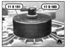
13. Перед заполнением герметиком кисть с праймером Loctite, номер изготовителя 171000 ввести как можно глубже в канавки (1) на сальнике и смазать соединение картера на блоке цилиндров.
