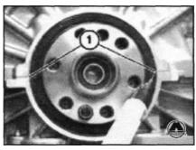
15. Смазать поверхность герметика в обеих канавках (1) праймером Loctite, номер изготовителя 171000.
