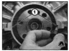
14.Полностью заполнить обе канавки (1) герметиком Loctite, номер изготовителя 193140.
