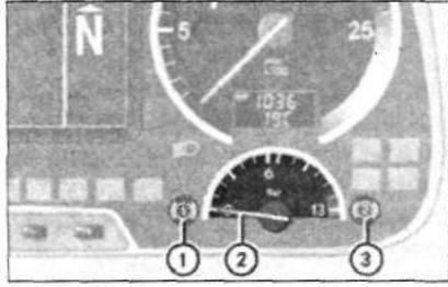
Тормозной контур с более низким давлением воздуха в ресивере индицируется контрольной лампой 1 или 3. На указателе 2 индицируется давление воздуха в ресивере соответствующего тормозного контура. Давление воздуха в ресиверах обоих тормозных контуров можно проверить в меню **КОНТРОЛЬНАЯ ИНФОРМАЦИЯ, ДАВЛЕНИЕ ВОЗД. В РЕСИВЕРЕ.**
