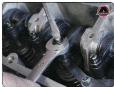
• Вкрутить или отвернуть регулировочный винт, пока щуп не будет слегка защемляться между стержнем клапана и наконечником регулировочного винта коромысла.
