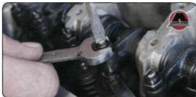
• Проверить зазор еще раз и при необходимости повторить регулировку.
