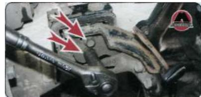
3. Отвернуть две гайки крепления кронштейна к правой передней подушке.
