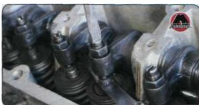
• Удерживая регулировочный винт, затянуть контргайку.
