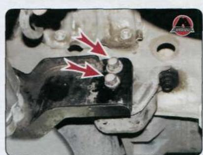
3. Отвернуть две гайки крепления левой передней подушки.
