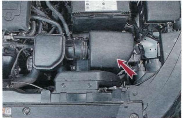
Его фильтрующий элемент — сменный, выполнен из специальной бумаги. Он задерживает все твердые частицы, способные повредить двигатель. Очистку и замену фильтрующего элемента (номер по каталогу 28113-25000) проводим в соответствии с **планом технического обслуживания**. Также для выполнения ряда работ в моторном отсеке может понадобиться снять корпус воздушного фильтра и воздухоподводящий патрубок.
