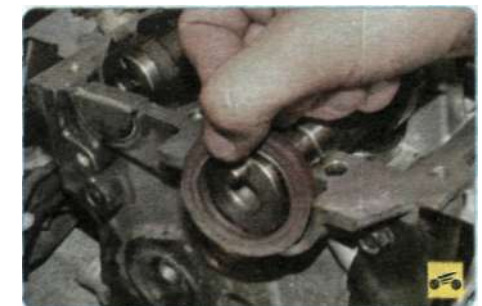
6. ...снимите крышку переднего подшипника распределительного вала выпускных клапанов...
