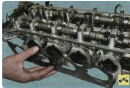
23. ...и снимите со шпилек прокладку.
