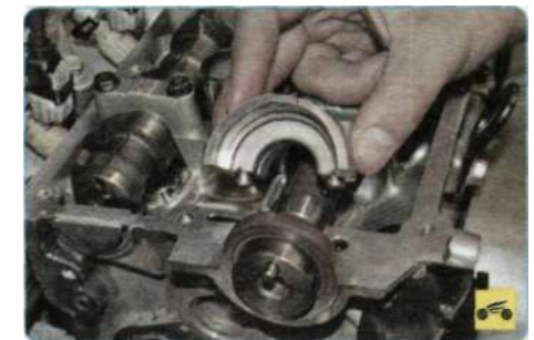
6. ...снимите крышку переднего подшипника распределительного вала выпускных клапанов...
