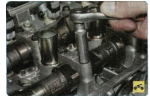
5. Выверните болты крепления крышек подшипников распределительных валов...
