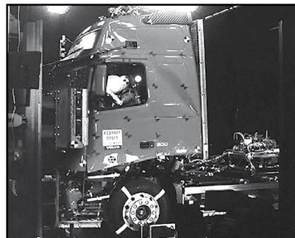
Инженеры компании не обошли стороной и пассивную безопасность грузовика. Каркас кабины сделан из прочнейшей стали, а ударопоглощающие балки и двери выполнены из деформируемого металла. В процессе создания было пройдено несколько тысяч смоделированных и около ста реальных краш-тестов, чтобы Volvo FH по праву назывался самым безопасным грузовым автомобилем в истории.
