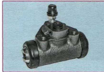
9. Установите рабочий цилиндр в порядке, обратном снятию. Гайку штуцера трубки затяните моментом 15-18 Н·м.
