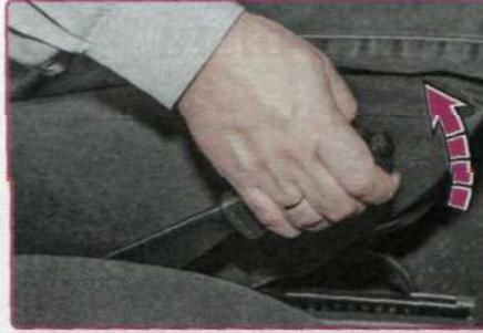
8. Немного поднимите рычаг стояночного тормоза - верхние концы колодок отойдут от упоров поршней рабочего цилиндра, а затем снимите цилиндр.
