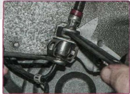
2. Отверните гайку тормозной трубки от шланга, удерживая вторым ключом наконечник шланга от проворачивания.
