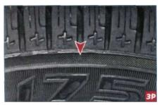
В местах нахождения индикаторов износа на боковинах шин нанесены метки в виде букв TWI.
