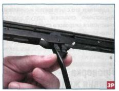
**Нажимаем** на **язычок** фиксатора шетки...
