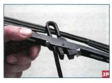
...и сдвигаем щетку вниз с крюка рычага, так чтобы фиксатор щетки вышел из крюка.
