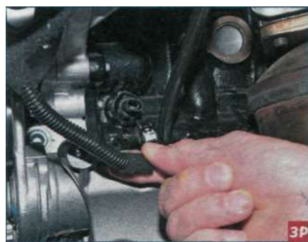
...и, нажав на фиксатор, отсоединяем колодку от разъема датчика сигнализатора недостаточного давления масла.
