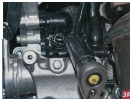
Высокой головкой «на 24» выворачиваем датчик из отверстия в блоке цилиндров...
