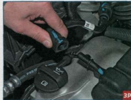
...отсоединяем наконечник трубки от штуцера крышки катушек зажигания.
