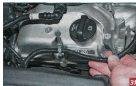
Вынимаем два держателя жгута проводов из отверстий в крышке головки блока цилиндров.
