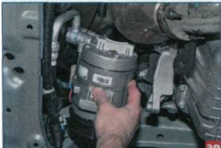
...отводим его от двигателя и оставляем подвешенным на трубках.
