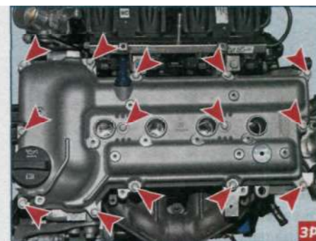
Расположение болтов крепления крышки головки блока цилиндров (для наглядности показано на демонтированном двигателе).
