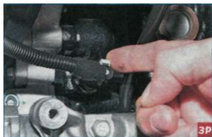
Сдвигаем стопор фиксатора колодки провода...
