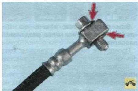
Наконечник шланга с двух сторон уплотнен медными шайбами. При каждой разборке соединения заменяйте шайбы новыми.
