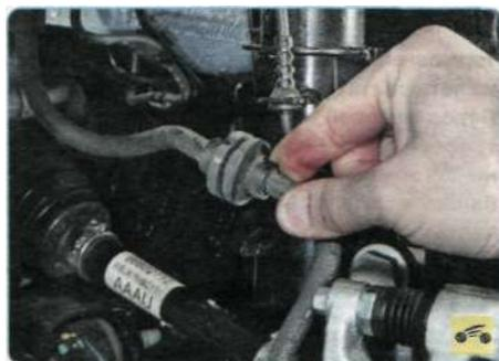
4. Извлеките фиксатор шланга из прорези кронштейна на амортизаторной стойке передней подвески.
