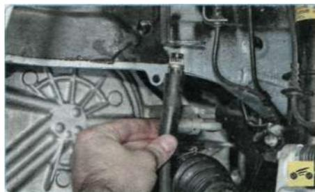
7. ...извлеките верхний наконечник из кронштейна на кузове и снимите шланг.
