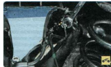
2. Отверните гайку крепления наконечника тормозной трубки к наконечнику тормозного шланга на кронштейне рычага балки задней подвески...
