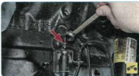
5. Отверните гайку крепления трубки к верхнему наконечнику...
