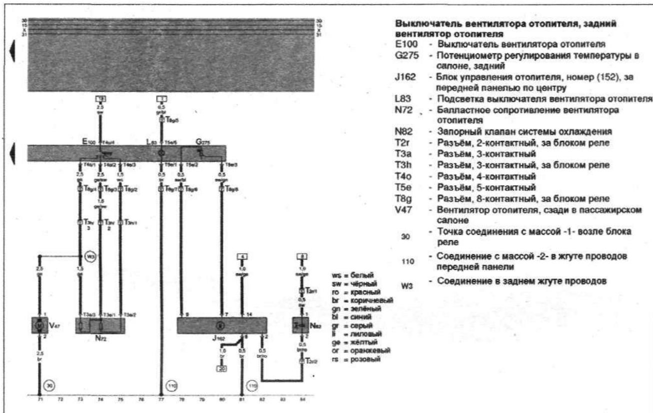
Климатическая установка. 2,4 л атмосферный дизельный двигатель, 55 кВт, АЖА, автомобили с короткой передней частью с августа 1998 года
