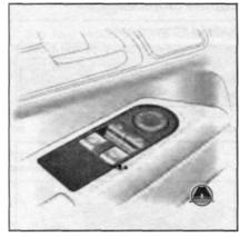
Для подъема и опускания стекол используйте органы управления. На автомобилях с электрическими стеклоподъемниками, для прекращения движения стекла вытяните или нажмите выключатель еще раз.
