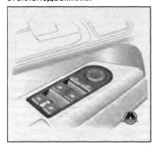
Выключатель 29 может использоваться для включения и выключения стеклоподъемников задних дверей.
