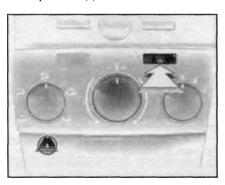
Включается при нажатии кнопки Щ}. Обогрев включается только при работающем двигателе и через короткое время отключается. В зависимости от типа двигателя, обогрев заднего стекла автоматически включается во время очистки дизельного сажевого фильтра.
