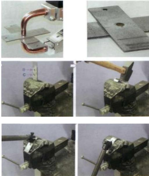
Фото. Процесс сварки и проверки качества шва. (GYS)
