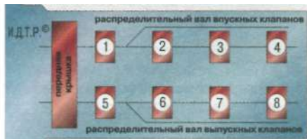
Рис. 5.5. Схема установки крышек распределительных валов двигателя ЗМЗ-409
