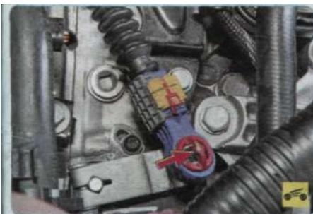
1. Управляют автоматической коробкой передач с помощью одного троса. Для его отсоединения от коробки передач сожмите фиксаторы на вкладыше наконечника и снимите наконечник троса с вкладыша (см. примечание). Вкладыш при этом останется на шаровом пальце рычага многофункционального переключателя. При необходимости снимите его с шарового пальца.
