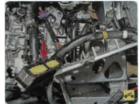
6. Отсоедините от блока колодку жгута проводов (показана на рисунке стрелкой), выдвинув ее фиксатор. Отверните гайки крепления блока управления к полке аккумуляторной батареи и снимите блок.
