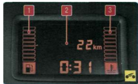
Рис. 1.10. Информационный дисплей: 1 - указатель уровня топлива; 2 - поле отображения информации с бортового компьютера и часы; 3 - указатель температуры охлаждающей жидкости двигателя
