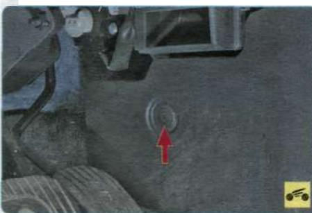
14. Выверните фиксаторы пистонов и извлеките пистоны крепления боковых облицовок тоннеля пола с двух сторон.
