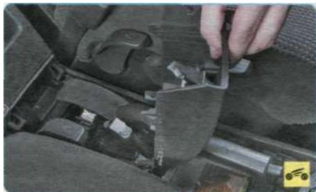
7. Окончательно снимите накладку рычага стояночного тормоза.
