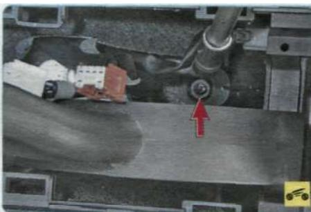
11. ...и гайку под накладкой рычага стояночного тормоза.
