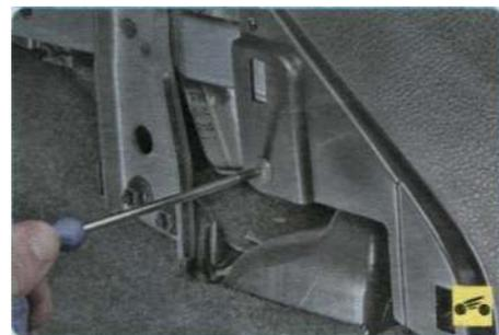
16. Выверните винты переднего крепления облицовки тоннеля пола с двух сторон.
