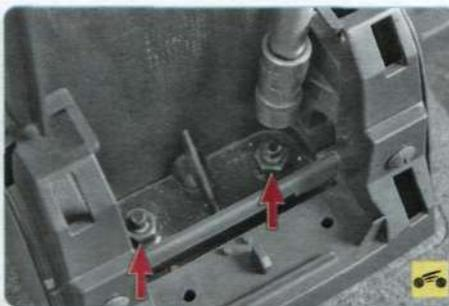
10. Отверните две гайки заднего крепления подлокотника к основанию кузова...
