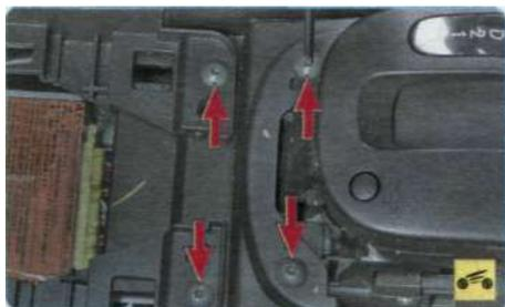
8. Выверните два винта крепления облицовки тоннеля пола и два винта переднего крепления подлокотника к основанию кузова.
