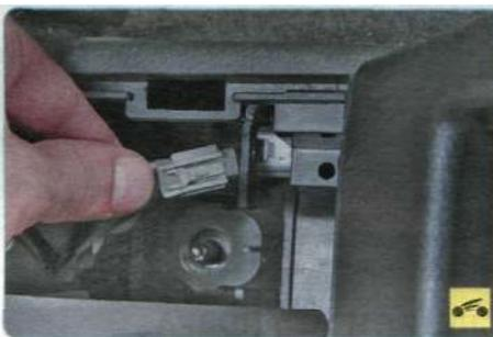
12. Отожмите фиксатор и отсоедините колодку жгута проводов от разъема антенны системы интеллектуального ключа.
