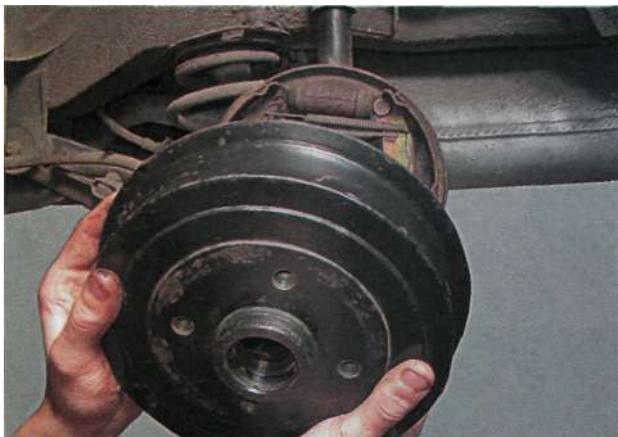
9. Если будет устанавливаться старый барабан, очищаем его внутреннюю поверхность специальным очистителем.
