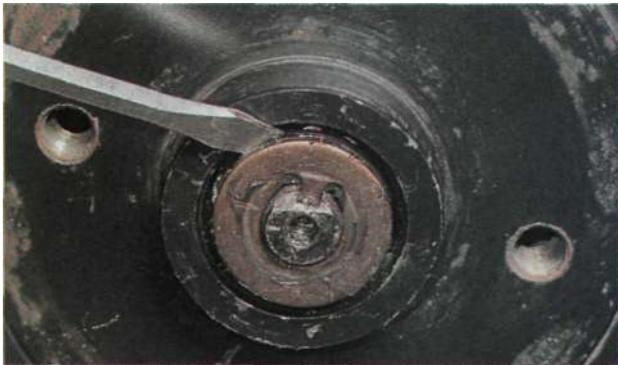
7. Снимаем наружный подшипник.
