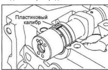
г) Осторожно установите крышки подшипников распределительных валов на головку блока цилиндров и затяните болты крепления номинальным моментом в два-три приема в порядке, указанном на рисунке.
