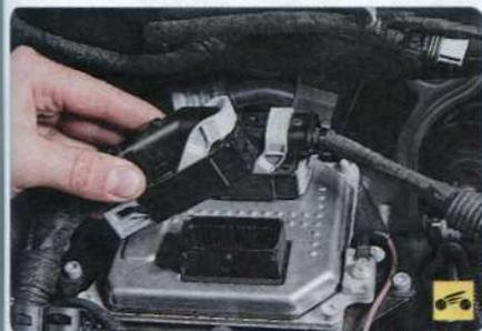
4. ...и отсоедините колодку от электронного блока управления двигателем.
