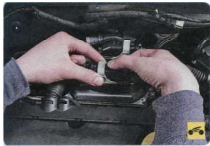
2. Нажмите на фиксатор держателя колодки жгута проводов...
