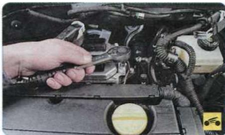
6. Выверните болт крепления наконечника «массового» провода к основанию электронного блока управления двигателем и отсоедините провод.
