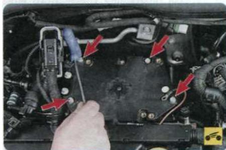
12. Выверните четыре болта крепления кронштейна к впускной трубе...
