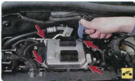
7. Выверните четыре болта крепления электронного блока управления двигателем к кронштейну на впускной трубе...
