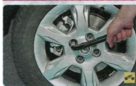
9. Проверьте затяжку болтов крепления колес и при необходимости затяните их моментом 105 Н-м\*
