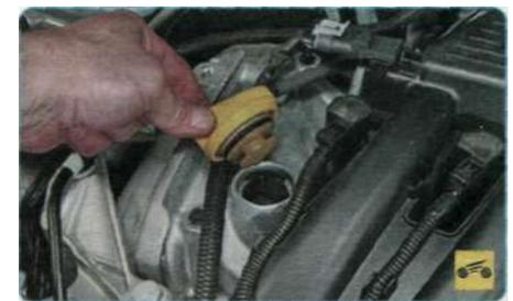
3. Для доливки масла поверните пробку маслоналивной горловины против часовой стрелки и извлеките ее из маслоналивной горловины.
