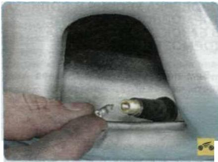
6. Нанесите на вентиль жидкость так, чтобы она заполнила собой полость вентиля. При дальнейшем образовании пузырьков и невозможности повернуть золотник, замените его. Если замена не помогла, замените вентиль.
