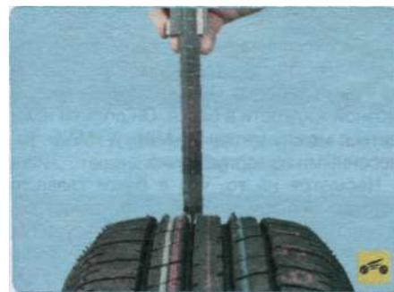
7. Измерьте штангенциркулем остаточную глубину протектора. Если глубина протектора 1,6 мм или меньше, замените шину.
