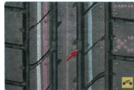
8. Если под рукой нет штангенциркуля, то глубину протектора можно проверить визуально по индикаторам износа шины в виде сплошных поперечных полос, проявляющихся на протекторе при его максимальном износе.
