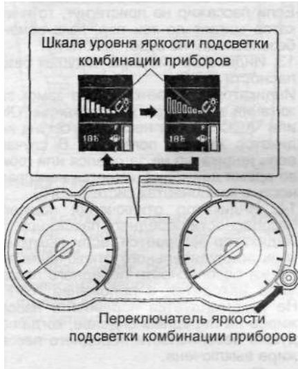
Комбинация приборов. 1 - спидометр, 2 - многофункциональный дисплей комбинации приборов, 3 - тахометр, 4 - переключатель яркости подсветки комбинации приборов и органов управления панели приборов.
