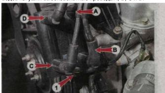
3. Подсоединяем щупы мультиметра в режиме вольтметра к контакту В колодки жгута проводов. При включении зажигания вольтметр должен показать напряжение аккумуляторной батареи. В противном случае проверяем электрическую цепь до реле зажигания **Er2** (с. 262. «Блок предохранителей и реле»).
