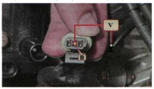
4. Мультиметром в режиме омметра измеряем сопротивление на высоковольтных выводах А-В и С-D. У исправной катушки сопротивление должно быть в пределах 8,9-10,8 кОм. Если сопротивление отсутствует или отличается, катушку заменяем.
