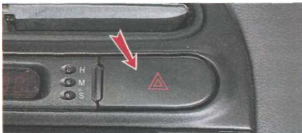
Аварийная сигнализация работает независимо от положения ключа в замке зажигания.
