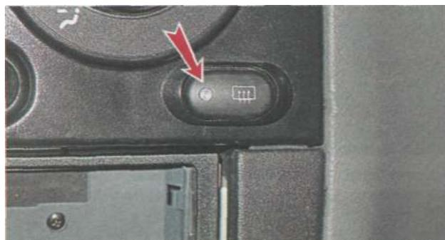
Электрообогрев работает только при включенном зажигании (ключ зажигания в положении ON).
