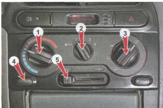
**Блок управления климатической установкой:** 1 — регулятор температуры поступающего в салон воздуха; 2 — регулятор скорости вращения электровентилятора; 3 — регулятор режимов распределения потоков воздуха; 4 — выключатель системы кондиционирования\*; 5 — рукоятка привода заслонки рециркуляции.
