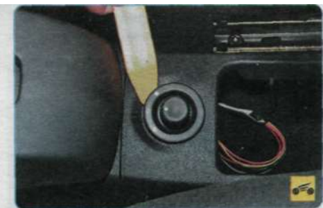
4. Отожмите фиксатор джойстика управления наружными зеркалами...
