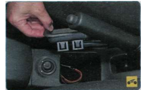
3. ...и извлеките его из окна в задней части облицовки тоннеля пола, преодолевая сопротивление его пружинных фиксаторов.
