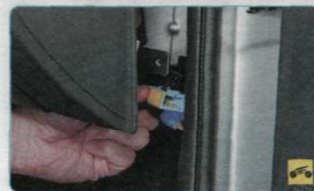
30. ...и, выдвинув его, разъедините колодку.
