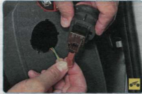
28. Снимите выключатель подушки безопасности переднего пассажира (см. «Снятие и установка выключателя подушки безопасности переднего пассажира», с. 287).
