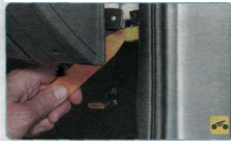
29. Немного отведите панель от каркаса, подденьте фиксатор колодки жгута проводов подушки безопасности переднего пассажира...
