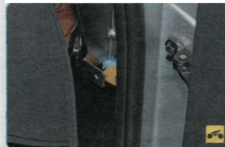
30. ...и, выдвинув его, разъедините колодку.
