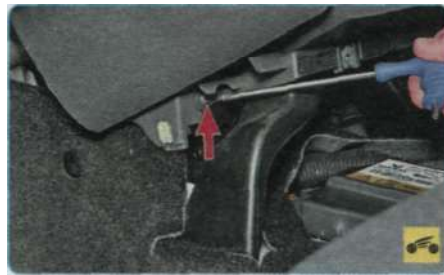
25. Выверните нижний винт крепления панели к каркасу.
