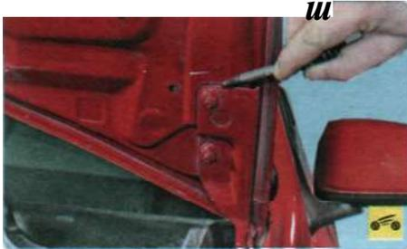
5. Если будете устанавливать прежний капот, промаркируйте расположение кронштейнов петель относительно капота, обведя их, например, маркером.
