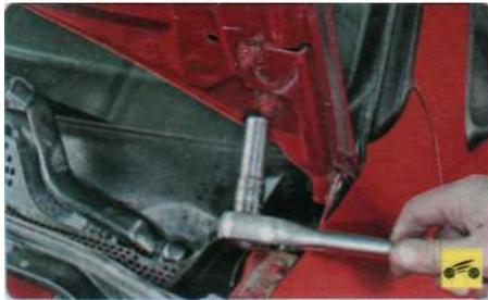
6. Отверните с каждой стороны по две гайки крепления капота к петлям и снимите капот.
