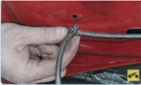
4. ...и извлеките его из отверстия во внутренней панели капота.
