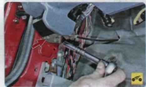
3. Выверните два болта крепления рычага привода замка капота.
