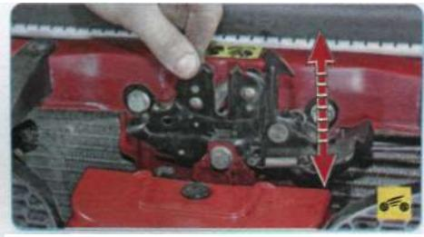
7. Если после установки замок нечетко запирается или с трудом отпирается, отрегулируйте его положение. Ослабьте болты крепления замка и перемещением его по вертикали в пределах овальных отверстий корпуса добейтесь четкой работы замка.
