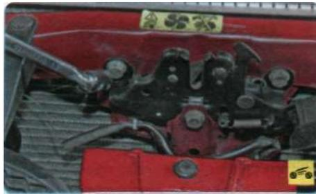
1. Выверните три болта крепления замка капота...
