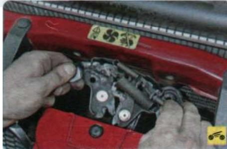
3. Выведите наконечник оболочки троса привода замка капота из держателя на корпусе замка.
