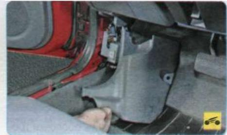
2. Отверните гайку крепления передней облицовки боковины кузова и снимите облицовку.
