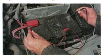
Сравниваем полученный результат со значениями, указанными в таблице, для определения степени зараженности батареи. Аккумуляторную батарею, разряженную на 50 % и более, заряжаем (с. 165, «Аккумуляторная батарея — зарядка»). На обслуживаемой или малообслуживаемой батарее более точно оценить ее состояние можно, определив плотность электролита в каждом из ее аккумуляторов (с. 165, «Аккумуляторная батарея — зарядка»).
