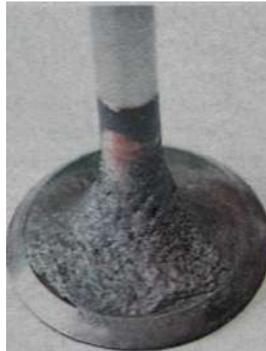
...деформаций, обгоревших участков и неравномерного износа. При наличии нагара удаляем его металлической щёткой и очищенную поверхность обрабатываем ветошью, смоченной в керосине.
