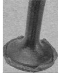
Прижимая клапан к седлу, поворачиваем его из стороны в сторону. После 10—12 движений поворачиваем клапан на 90° и продолжаем притирку. Притирку проводим до образования равномерного светло-серого кольцеобразного пояса шириной 1,1—1,4 мм на тарелке клапана и его седле.
