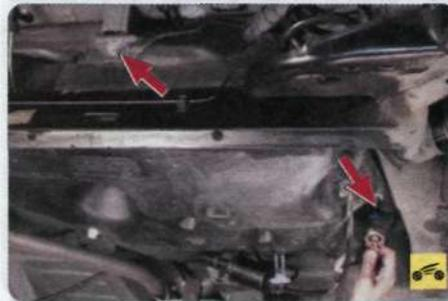
17. Аналогично отверните гайку и выверните болт крепления топливного бака с правой стороны.
