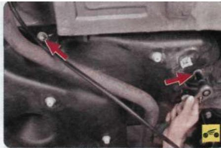
16. Отверните гайку и выверните болт крепления топливного бака с левой стороны.
