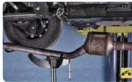
19. ...и положите на дополнительную опору (например, на гидравлическую стойку).
