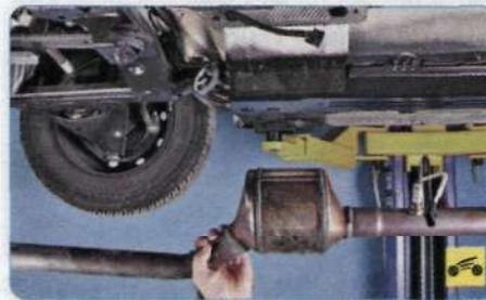
18. Снимите подушки системы выпуска отработавших газов, поверните ее...
