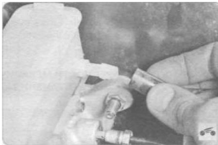
4. ...затем отсоедините питающий шланг от патрубка бачка главного тормозного цилиндра и снимите шланг.
