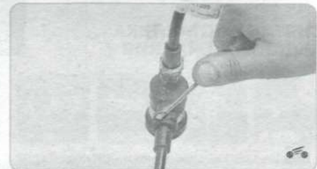
10. Для снятия трубки от демпфера до рабочего цилиндра выключения сцепления подденьте отверткой пружинный фиксатор наконечника трубки со стороны демпфера...
