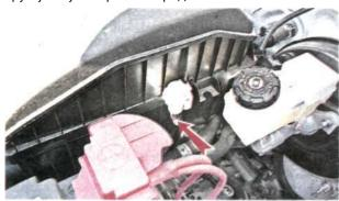
3. Отсоединяем от корпуса воздушного фильтра патрубок подвода воздуха.
