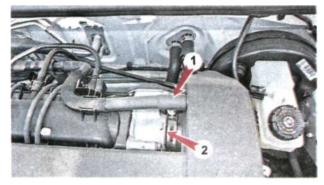
5. Приподнимаем корпус фильтра, снимая его с держателей на двигателе.
