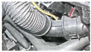
4. Отсоединяем от патрубка фильтра шланг системы вентиляции картера 1 и ослабляем хомут крепления 2 корпуса воздушного фильтра к дроссельное му узлу.
