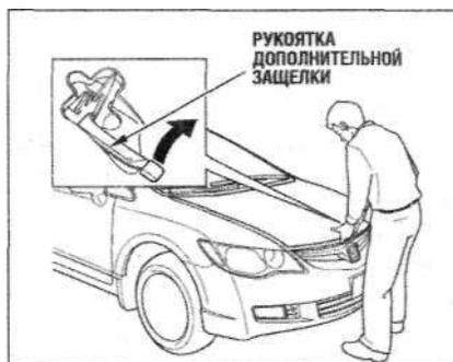
2. Стоя спереди автомобиля, просуньте пальцы руки под переднюю кромку капота. Нащупайте рукоятку дополнительной защелки капота, которая находится в центре, над эмблемой «Н». Нажмите на рукоятку вверх, чтобы отвести защелку и освободить капот. Поднимите капот. Если защелка капота отпирается с трудом, а также если капот можно открыть, нажимая на рукоятку защелки, необходимо очистить и смазать механизм защелки.
