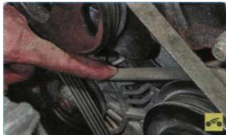
1. Проверьте, не оборван ли ремень привода генератора. Если произошел обрыв, замените ремень (см. «Проверка натяжения, регулировка и замена ремней привода вспомогательных агрегатов», с. 67).
