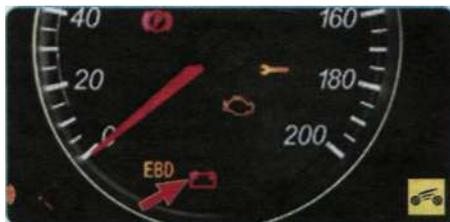
Если в комбинации приборов горит красная сигнальная лампа разряда аккумуляторной батареи, значит, ток не поступает от генератора в бортовую сеть и расходуется запас энергии аккумуляторной батареи. Эксплуатация автомобиля с горящей сигнальной лампой разряда аккумуляторной батареи недопустима, так как иногда причиной загорания лампы может быть короткое замыкание проводки, приводящее к пожару в моторном отсеке автомобиля. Остановите автомобиль, заглушите двигатель
