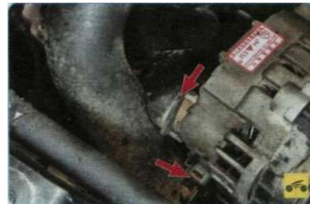
6. ...и генератору. Провода могут быть оборваны, обломаны внутри изоляции или с окисленными или ненадежными контактами. Устраните неисправность и пустите двигатель. Если появился ток зарядки, можно продолжать движение.
