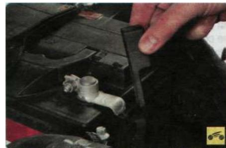
4. ...и клемме «минус» аккумуляторной батареи (защитный колпачок клеммы для наглядности снят)...
