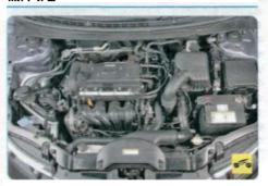
4. Внимательно осмотрите двигатель и подкапотное пространство. Обратите внимание на потеки бензина, масла, тормозной и охлаждающей жидкостей. Убедитесь в целости электропроводки. Проверьте посадку колодок жгутов низковольтных проводов в разъемах катушек зажигания, затяжку болтов крепления катушек зажигания к крышке головки блока цилиндров.
