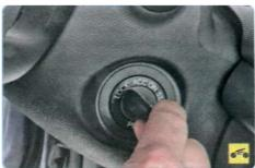
5. Не закрывая капот (в случае дождя или снегопада прикройте его), садитесь за руль. Включите зажигание, при этом включится электробензонасос. Пустите двигатель, повернув ключ в замке зажигания в положение «START».
