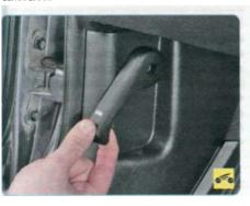
1. Потяните рукоятку привода замка капота, откройте капот...
