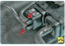
Помимо перечисленных основных причин, двигатель может не пускаться при неисправности клапана продувки адсорбера или при подсосе воздуха через соединения шлангов системы улавливания паров топлива.
