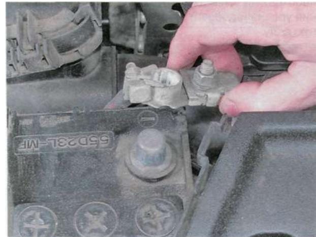
7. Снимаем с положительного вывода аккумуляторной батареи защитный колпачок.
