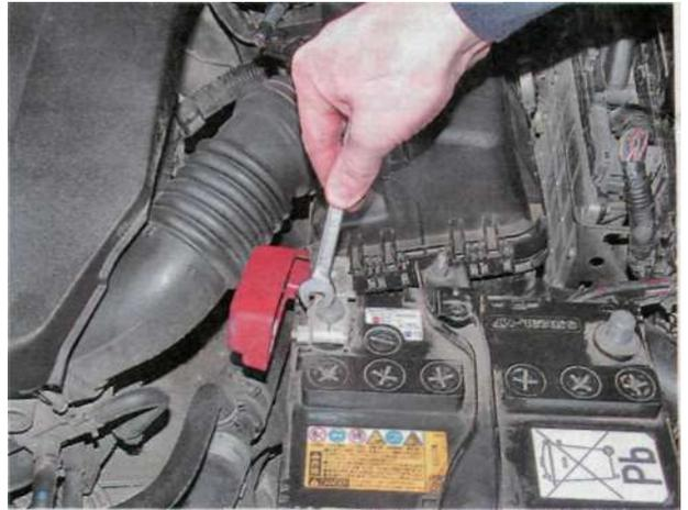
9. Осматриваем клеммы на предмет отсутствия окислов и повреждений. Проверяем надежность крепления клемм к проводам и при необходимости восстанавливаем соединения. Треснувшие клеммы (или клеммы в сборе с проводами) необходимо заменить. Внутренние поверхности клемм зачищаем до блеска с помощью специального приспособления или мелкозернистой наждачной бумаги.
