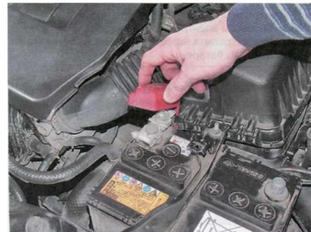
8. Ключом на 10 мм ослабляем гайку стяжного болта клеммы и снимаем клемму с положительного вывода.
