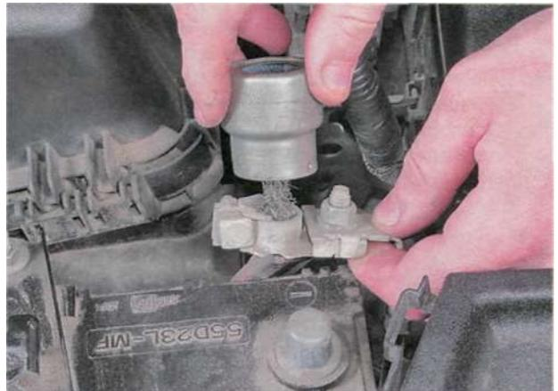
10. Специальным приспособлением или мелкозернистой наждачной бумагой зачищаем выводы аккумуляторной батареи.
