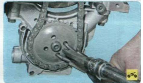
6. Выверните болт крепления звездочки масляного насоса, удерживая звездочку от проворачивания, и снимите ее.
