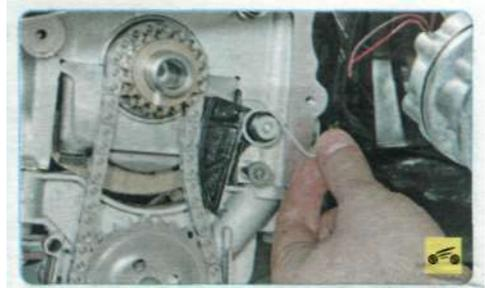
3. Снимите пружину натяжителя цепи привода масляного насоса.
