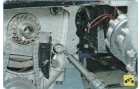
ните болт крепления натяжителя к блоку цилиндров...
