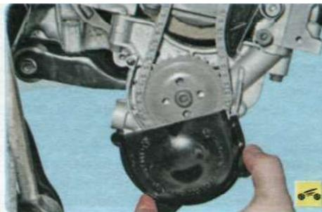
2. Снимите защитный кожух звездочки масляного насоса.
