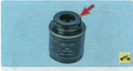
9. Смажьте уплотнительное кольцо нового фильтра чистым моторным маслом и заверните (руками без применения инструмента) фильтр на 4/5 оборота с момента соприкосновения уплотнительного кольца с фланцем блока цилиндров.
