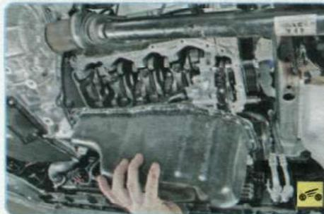
1. Снимите масляный картер (см. «Замене уплотнения масляного картера двигателя» г, 74)
