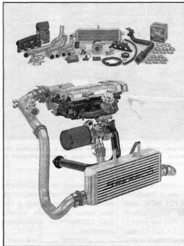
Хорошо спроектированная система для четырёхцилиндрового двигателя Honda. Обратите внимание на простой, но эффективный свариваемый по месту ("log-type") выпускной коллектор и короткий, прямо направленный трубопровод от компрессора к охладителю воздуха, и от охладителя к впускному коллектору. (Turbonetics)
