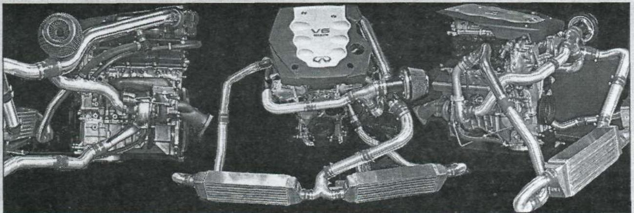
Модернизированная система турбонаддува Turbonetics, установленная на шестицилиндровый двигатель Nissan 350ZVQ35. (Turbonetics)
