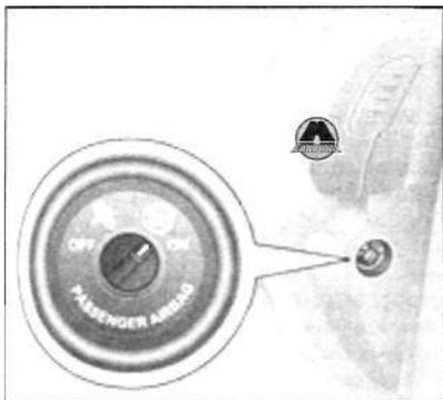
После включения зажигания необходимо убедиться, что контрольная лампа  $\text{OFF}$  включена на центральном дисплее или на панели приборов и (в зависимости от комплектации автомобиля) также отображается сообщение: «Passenger air bag off» («Подушка безопасности пассажира отключена»).
