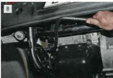
**Сдвигаем штангу стабилизатора к левому борту автомобиля так, чтобы ее правый конец вышел из пространства между двигателем и подрамником.**
