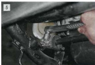
**Головкой "на 13" отворачиваем две гайки кронштейна крепления штанги стабилизатора.**
