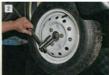
**Головкой "на 30" ослабляем гайку подшипника ступицы.**
