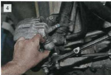
**Вращая, стягиваем стойку стабилизатора с конца штанги стабилизатора.**
