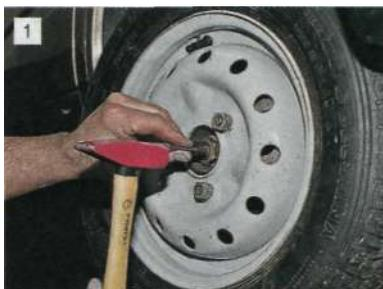
**Узким зубилом в двух местах управляем вмятый буртик гайки подшипника ступицы.**
