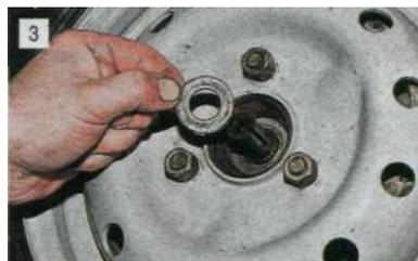
**...и снимаем шайбу.**
