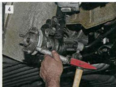
**Проворачивая ступицу, через выколотку из мягкого металла выбиваем ее из поворотного кулака.**
