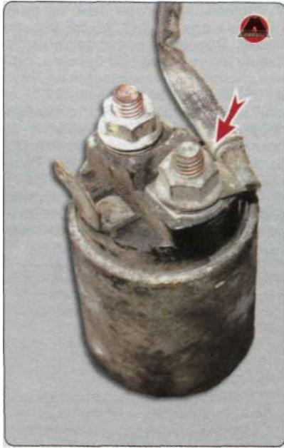
7. Отвернуть два винта и снять втягивающее реле.
