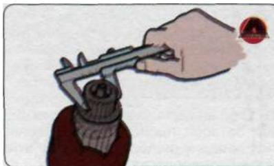
3. Проверить глубину слюды между сегментами коллектора и сопоставить полученные значения с указанными ниже. Если полученное значение меньше минимального, увеличить глубину, используя полотно ножовки.
