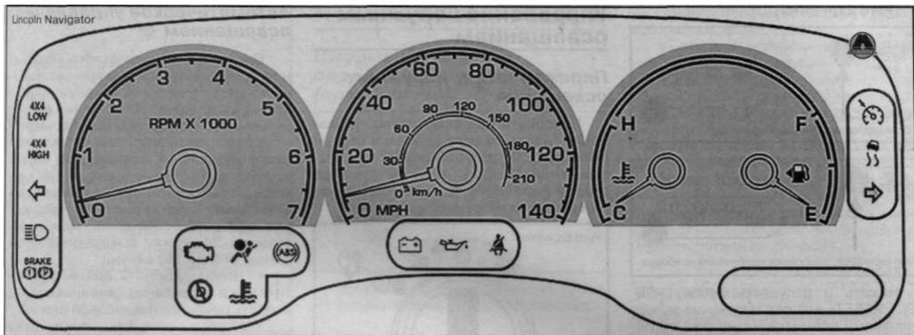
**Указатель температуры охлаждающей жидкости**
