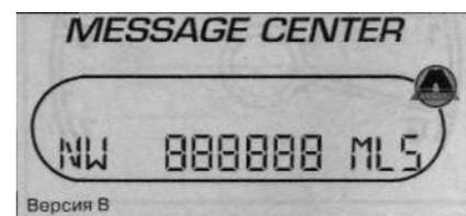
Одометр фиксирует общий пробег автомобиля.
