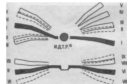
Рис 10.10. Положение рычагов подрулевых переключателей (жирными линиями показаны исходные положения тонкими - фиксированные положения, пунктир - нефиксированные положения рычагов)
