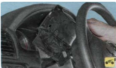
2. Снимите кожух рулевой колонки (см. «Снятие и установка кожуха рулевой колонки», с. 188).
