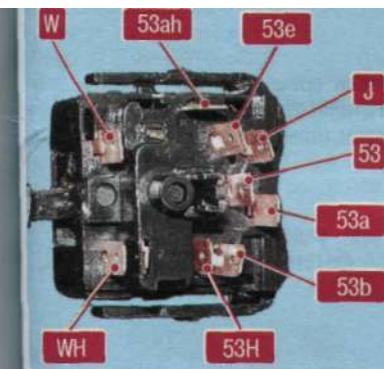
Рис 10.12. Номера контактов переключателя стеклоочистителя и стеклоомывателя
