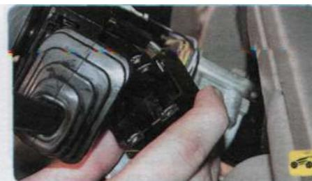
6. Отсоедините колодку жгута проводов от переключателя стеклоочистителя и стеклоомывателя...
