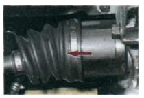
...и внутренних шарниров равных угловых скоростей, а также проверяем наличие подтекания масла из коробки передач через сальники внутренних шарниров приводов.
