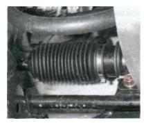
Проверяем состояние хомутов защитных чехлов рулевого механизма, надежность их крепления. Осматриваем защитные чехлы.
