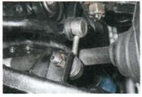
Проверяем состояние шаровых шарниров стоек переднего...
